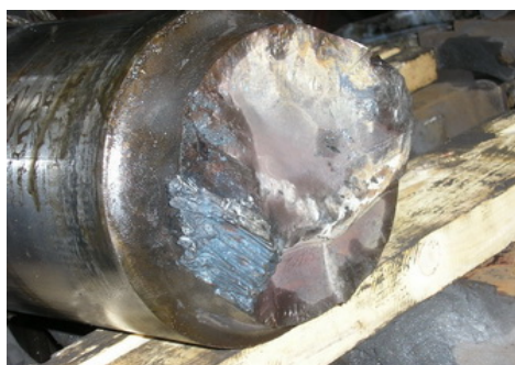
Slika 2 Prelom sa površinama braon boje (II) ostali deo preloma je posledica autogenog sečenja a na tom delu bilo čupanje materijala (I)
